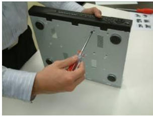
④安裝固定硬碟螺絲
