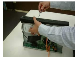
③安裝固定硬碟螺絲
