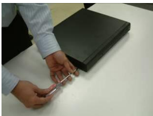
①拆卸主機上蓋的固定螺絲
